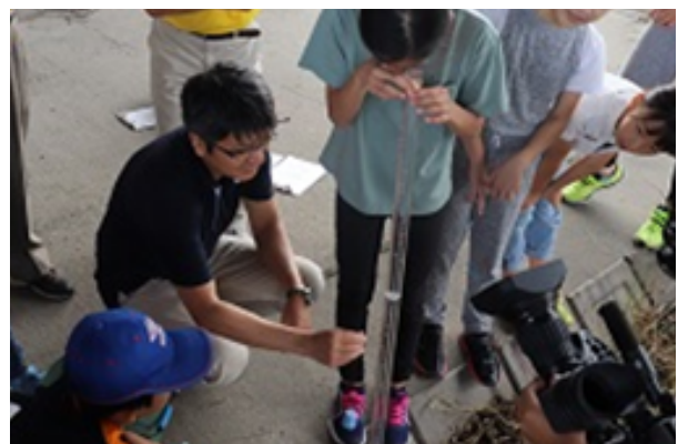
透視度計による水質測定の様子
